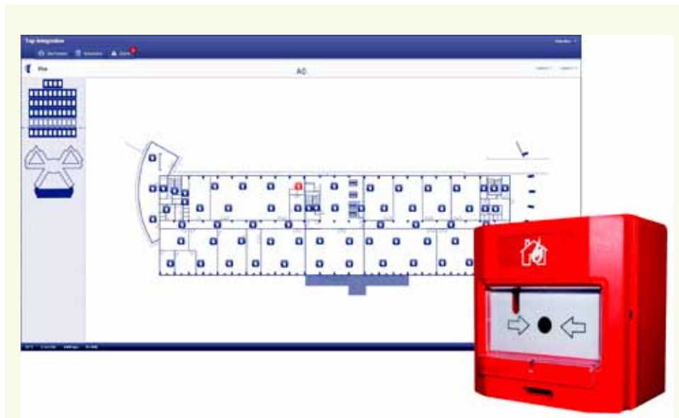
-Figuur 3- Brandmelding geïntegreerd met plattegrond in GBS + manueel brandmelden
