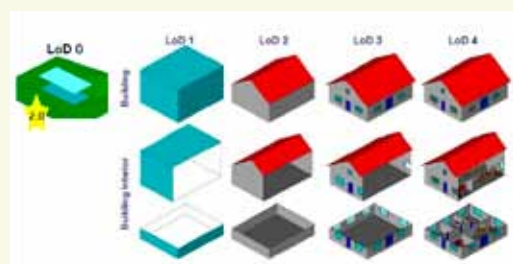
-Figuur 3- Level of detail van gebouwen. Van grafische objecten tot 3D gedetailleerde gebouwen met hun installaties
