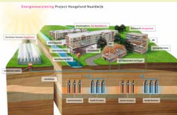
-Kader 3- Voorbeeldproject kassenwarmtesysteem Hoogeland
