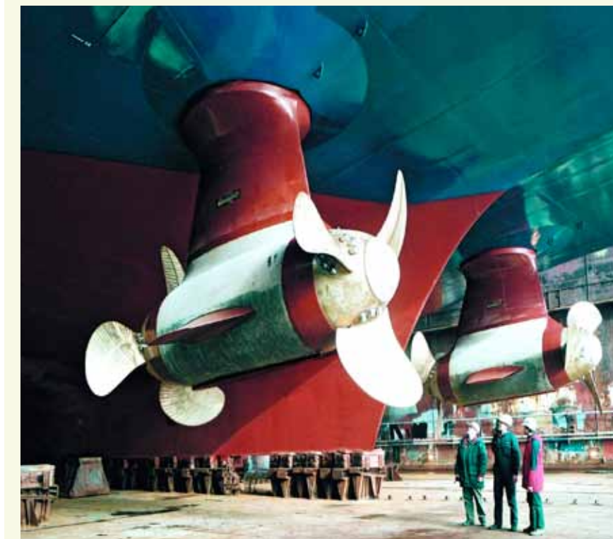
-Figuur 2- POD, een elektromotor in een waterdicht huis (foto Imtech Marine)
