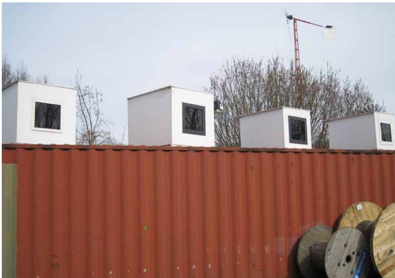
-Figuur 1- De vier ontwikkelde testboxen op de zeecontainer op de campus van Universiteit Twente met op de achtergrond het Davis weerstation
