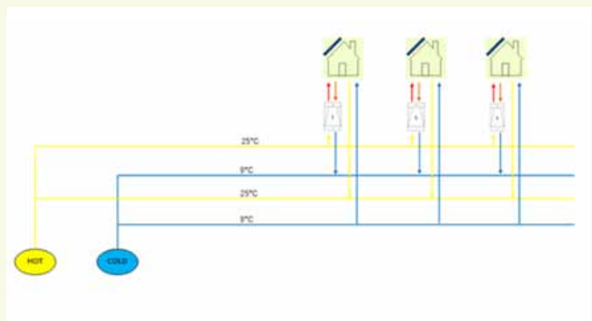
-Figuur 5- Collectief zonneverwarmingssysteem met individuele warmtepompen
