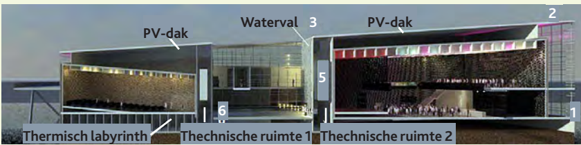
-Figuur 2- Principeopzet adiabatische koeling
