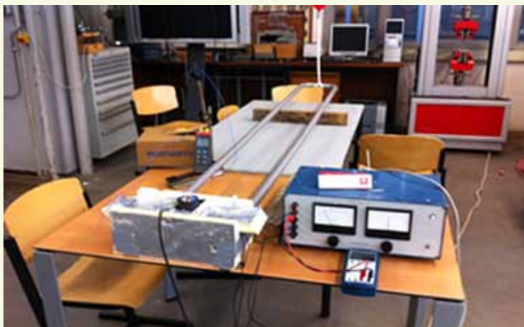
-Figuur 2- Proefopstelling van 15 mm koperen buis. De circulatiepomp is geïsoleerd met een doos van PIR-schuim
