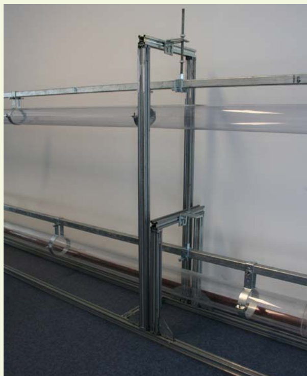
Opstelling voor onderzoek transportafstand fecale stoffen bij gebruik van waterbesparende closets (ST-12).
