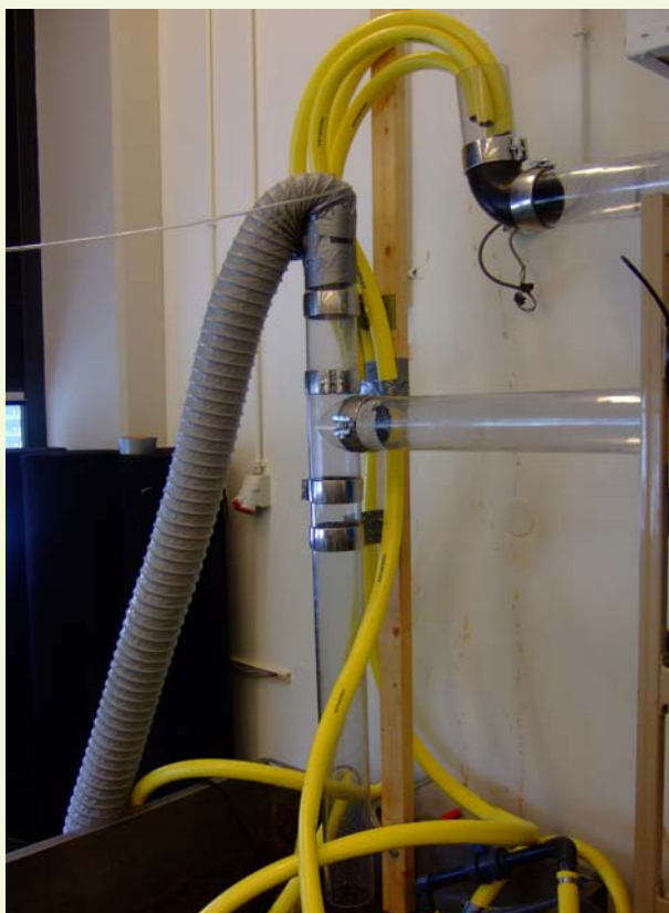
Onderzoek naar hydraulische afsluitingen in een standleiding van de riolering (ST-8)
