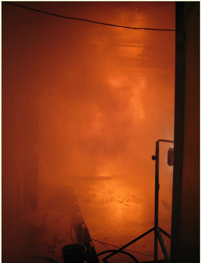
-Figuur 1- Watermiststelsel bij brand
