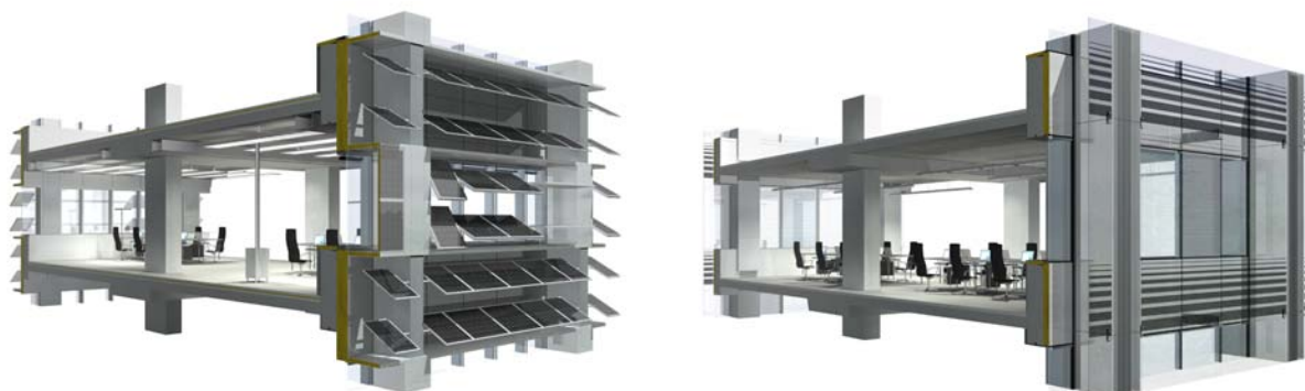
-Figuur 5- Hybride concepten: Hybride 1: 'passief-opwekking' en Hybride 2: 'schil, decentraal-opwekking'
