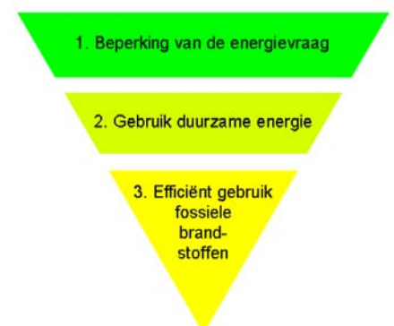
-Figuur 1- Trias energetica, stappen voor energiebesparing
