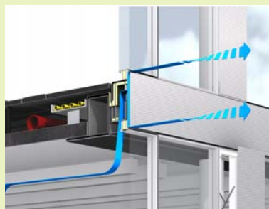
-Figuur 6- De staalconstructie van de laagbouw is opgebouwd uit speciaal ontworpen profielen en is op veel plaatsen lucht- of leidingvoerend.
