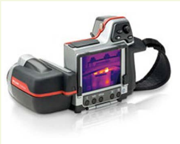
-Figuur 3- IR camera: een middenklasse infraroodcamera met een detectorresolutie van 320 x 240 pixels
