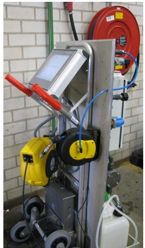
-Figuur 9- Geautomatiseerde keerklepcontrolesysteem.
