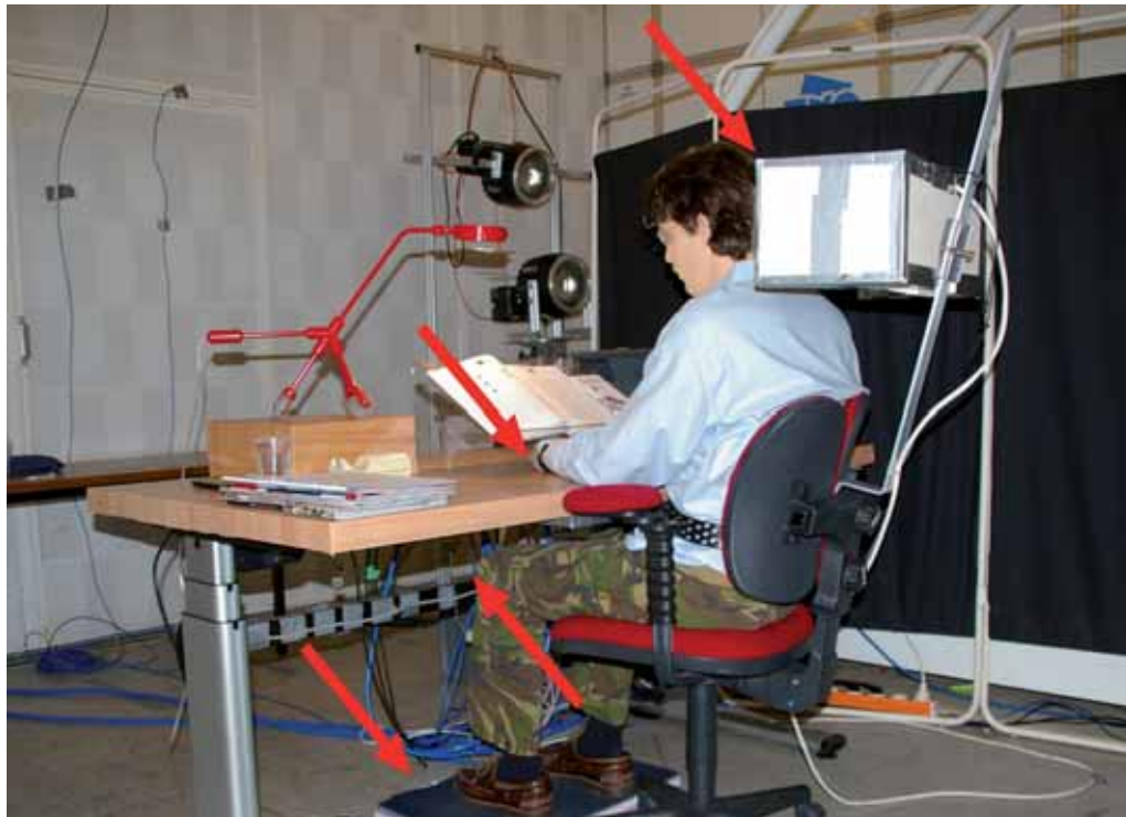
- Figuur 1 - Proefopstelling. De pijlen geven de positie van de stralingspanelen aan.
