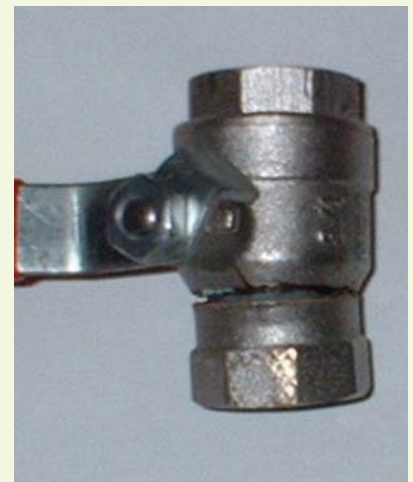
-Figuur 1- Kogelkraan gescheurd bij 3,5 x de nominale druk.
