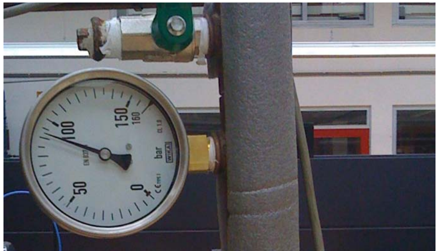
-Figuur 4- De druk bij het bezwijken van het ontluchtingsschroefje.
