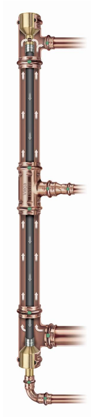
Figuur 15: Werkingsprincipe van het buis-in-buis circulatiesysteem (Bron: Viega).
