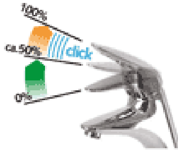
Figuur 8: Grotere volumestroom is alleen mogelijk na het overbruggen van een fysieke barriere (bron Venlo Sanitair).
