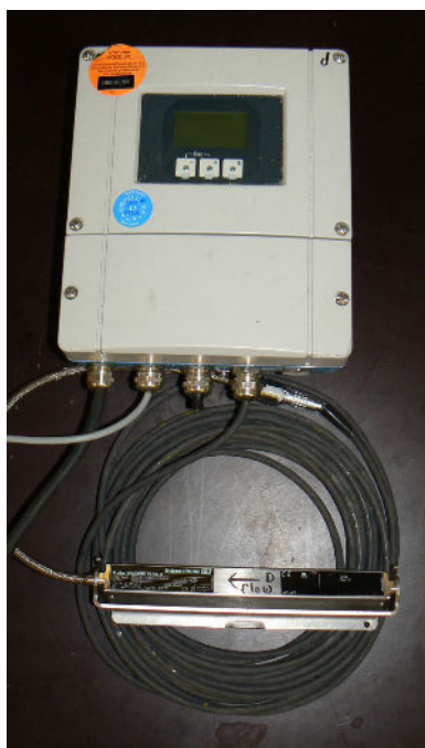
Figuur 3-1 Weergave van een Proline Prosonic volumestroommeter.
