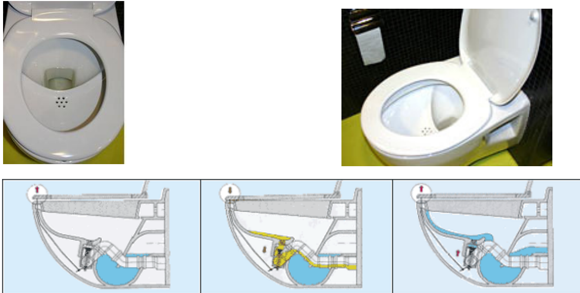
Figuur 4.3: Het Roovac toilet en het gepatenteerde scheidingsprincipe.
