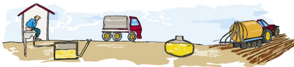
Figuur 1.1: Urine wordt opgevangen, getransporteerd, opgeslagen en bijvoorbeeld op het land gebruikt [Reest en Wieden 2008].
