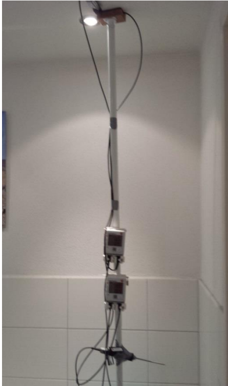
Foto 1.9 Plaatsing van de meetboom
