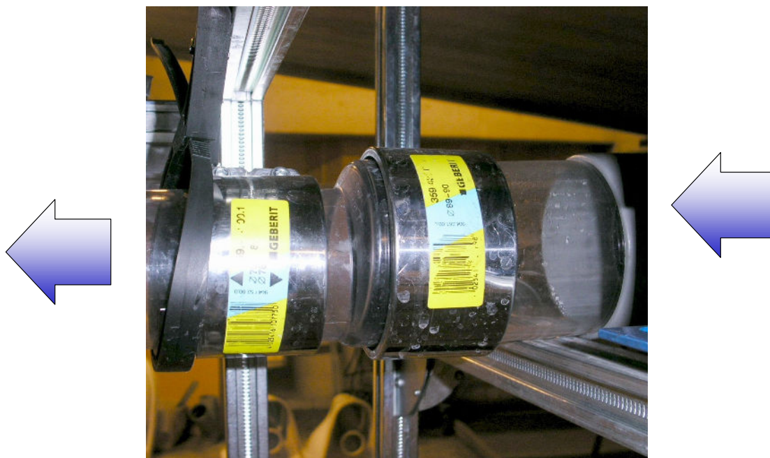
Figuur 6.7 Overgang inwendige middellijn van 84 mm. naar 69 mm.
