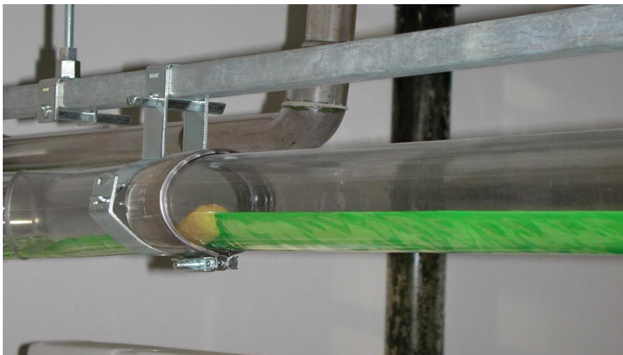
Foto 4: opstuwning water bij bocht
