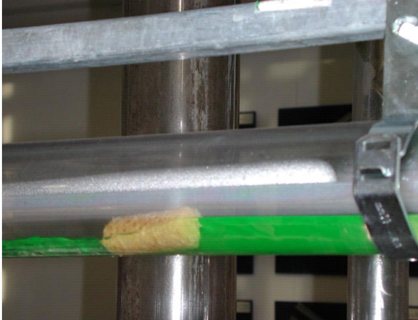
Foto 3: opstuwning water achter “vaste stof”
