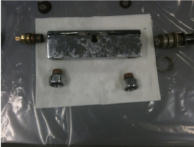
Figuur 3. Een kraan na demontage van de losse delen en voordat swabmonsters worden genomen.
