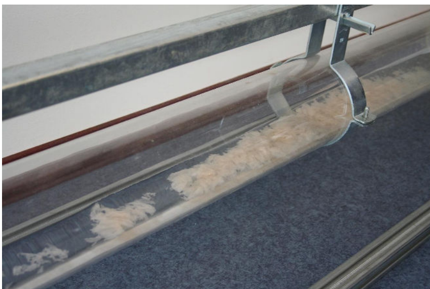
figuur 5. Het closetpapier zet lichtelijk uit en valt uiteen in een wollige massa dat aan het wateroppervlak blijft drijven.
