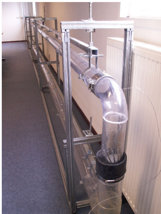
figuur 4-3 Meetopstelling van de grondleiding / huisaansluitleiding
