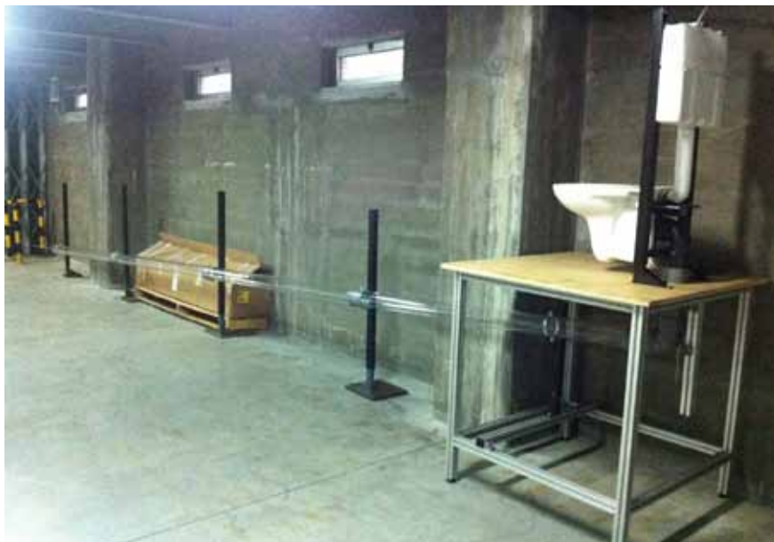
-Figuur 3- Testopstelling met closet en de horizontale afvoerleiding
