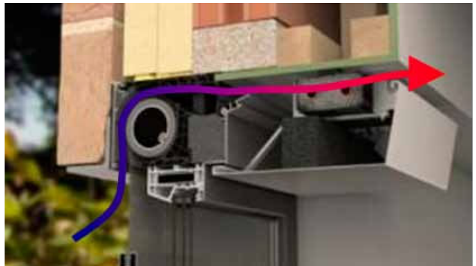
-Figuur 4- Doekzonwering met geïntegreerd verluchttingsrooster waarachter zich een convector en lichtgeleidingsplaat bevinden voor actieve voorverwarming van de buitenlucht
