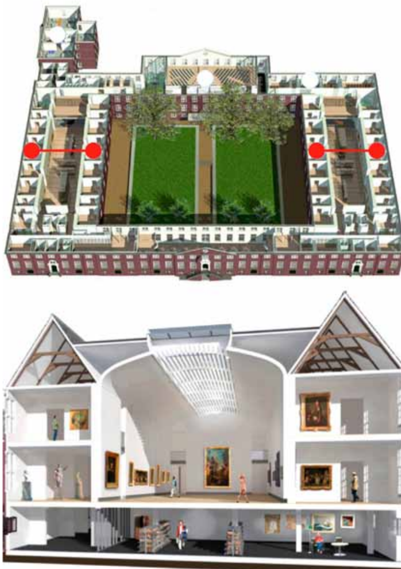
-Figuur 1- De plattegrond van de eerste verdieping omvat twee bijna identieke tentoonstellingsruimten (tussen de rode stippen), boven enrechts, en de doorsnede hiervan, onder
