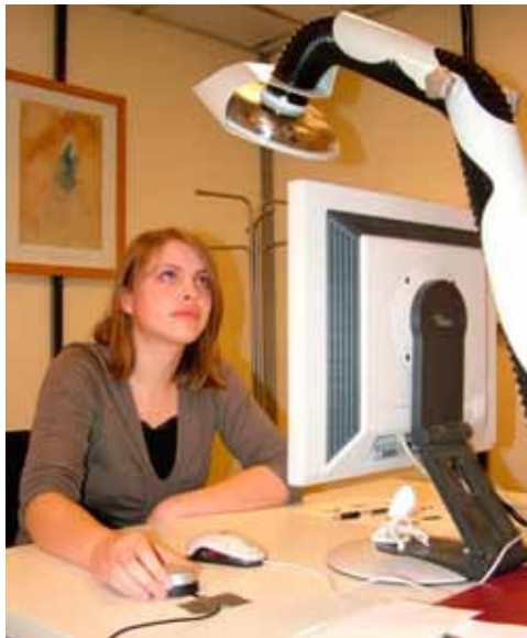
-Figuur 2- Foto van testopstelling voor een onderzoek naar de menselijke reactie op persoonlijke ventilatie [2]
