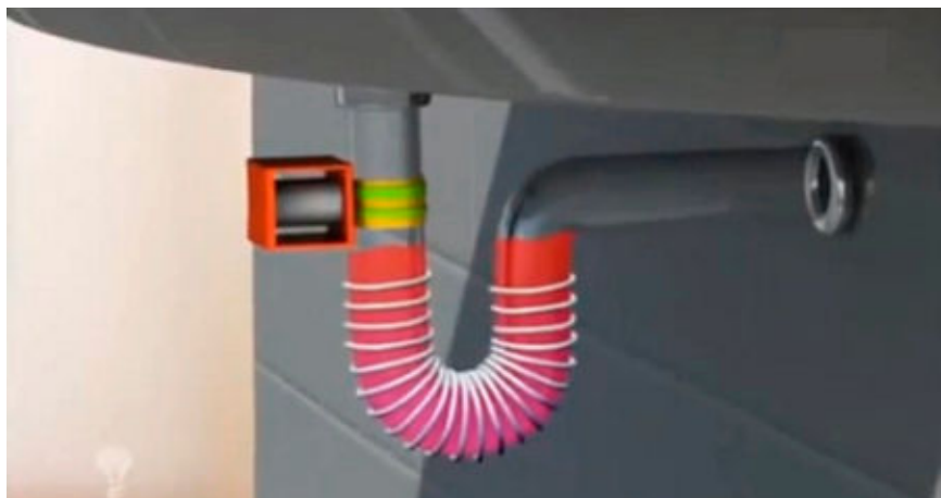
-Figuur 3- Thermische desinfectie met trillingsreiniger
