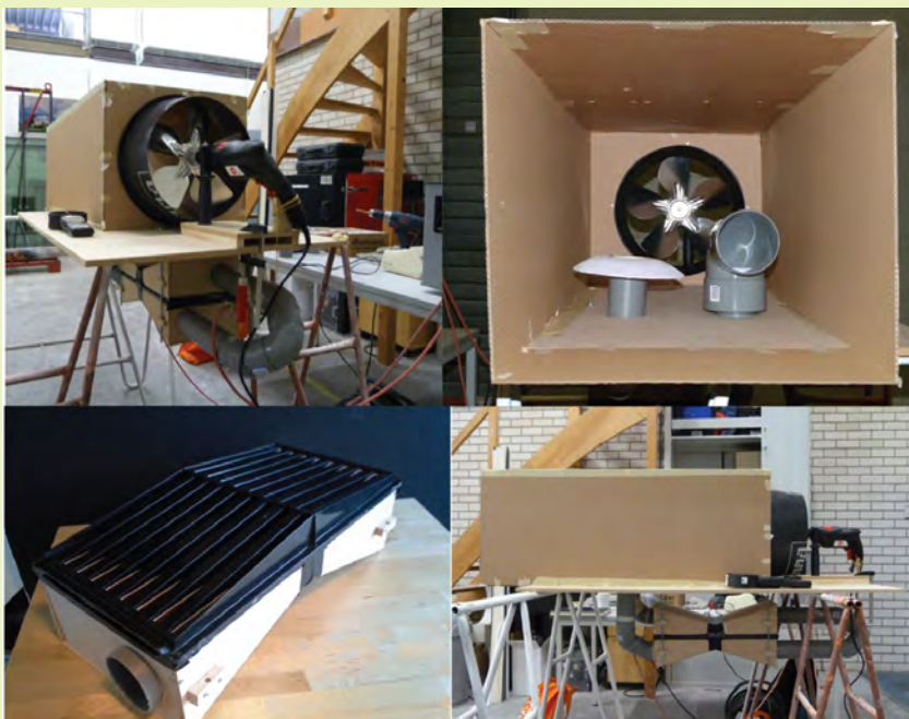
-Figuur 5- Test opstelling zoals toegepast in het laboratorium en de FiwiHex-warmtewisselaar (linksonder)
