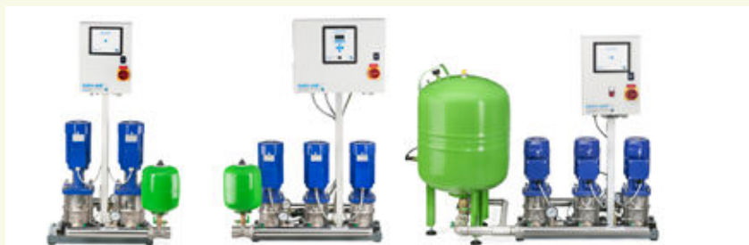
-Figuur 4- Alle uitvoeringen van de drukverhogingsinstallatie zijn volledig doorstromend. Van links naar rechts: standaard installatie, installatie met toerenregeling en een hoog rendement installatie met extra groot drukvat
