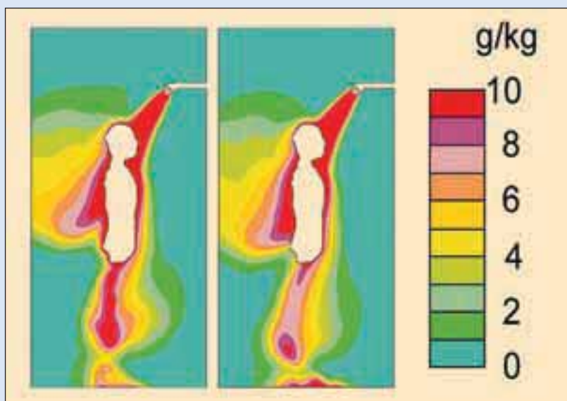
Berekend vochtgehalte in de doucheruimte. Links volumestroom 6 liter per minuut en rechts 15 liter per minuut.
