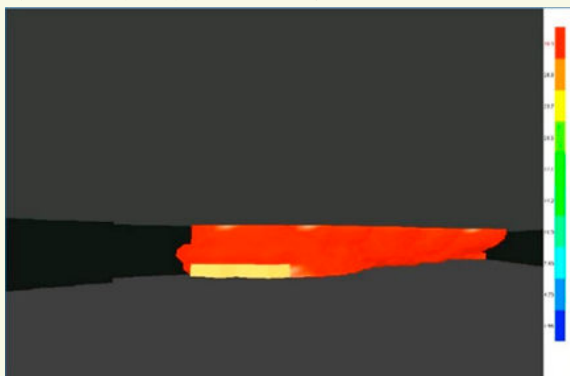
-Figuur 4- Brandweerinzet met mechanische 'wind in de rug' (o.b.v. 30 meter zichtlengte)
