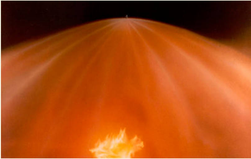
-Figuur 2- Sproeipatroon van het lagedruk-watermistsysteem
