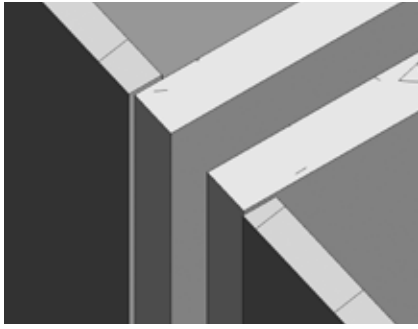
-Figuur 4- Niet gesloten wanden
