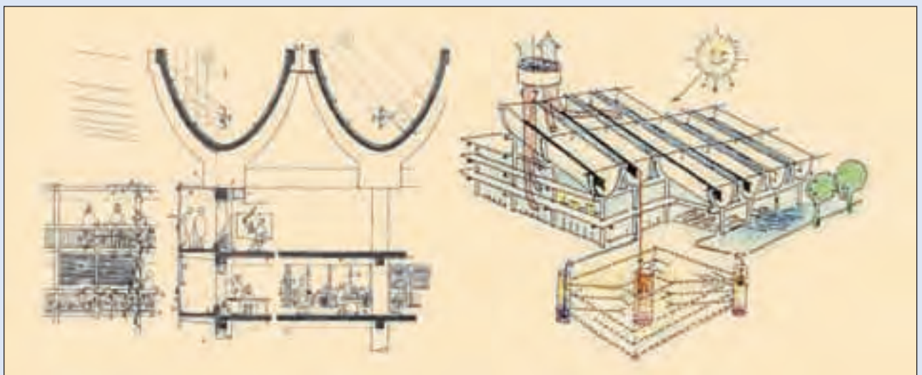
Ontwerpstadskantoor Lelystad, niet uitgevoerd eerste door zonnewarmte zelfvoorzienend gebouw van Nederland, 1977.
