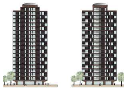
Figuur 8: Gevelbeelden Zuidgevel met zonneshoorstenen links – Oost- en Westgevel rechts.
